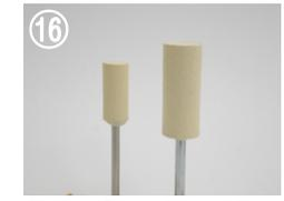
⑯ 最終工程のツヤ出し研磨に使用するクリスタルバー
