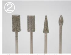
② 使用するのは粗削り用ダイヤモンドビットのJDS-01と・・・
