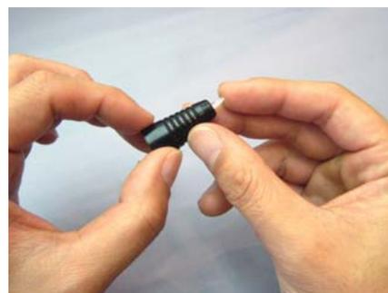
③先端の部分にプッシャーとバネが残っていますので、白い部分を押し中内部の部品を取り出します。バネが取りづらい場合は、ピンセットなどで引っ張って下さい。
