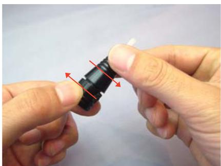
①プッシャーの先端と根本の部分を持って矢印の方向に回します。
