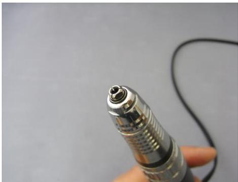
・左図のようにコレットチャックが開きましたら、ご使用になるビットを挿しこみセットリングをS(セット)側に回してビットが固定されていることを確認した後、通常にご使用いただける状態となります。
