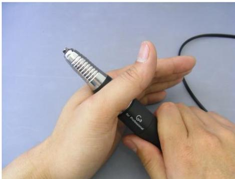
・セットリングを固定したままハンドピースを右の方向に回しますと先端コレットチャックのロックが解除されます。
