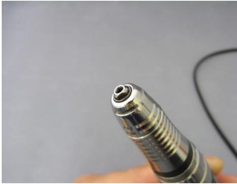
・先端にビットが挿さっていない状態でロックがかかって閉まった場合(セットリングがS(セット)側に回ってしまった場合)、通常よりも強く締め込んでしまいます。
