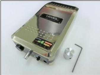
① スピード調整軸を MIN に回りきるまで回して下さい。
